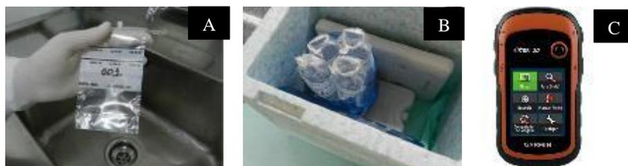
**Figura 1:** A) Saco plástico estéril de 100 ML c/ tiossulfato B) Acondicionamento das amostras em caixas de isopor C) GPS Garmin eTrex 20X
