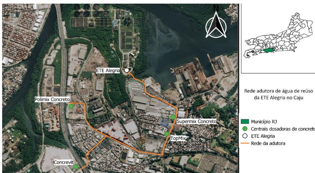
**Figura 2 - Traçado da rede de distribuição de água de reúso**
