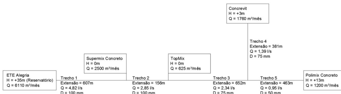
**Figura 3 - Diagrama unifilar de projeto de dimensionamento da rede de distribuição**
