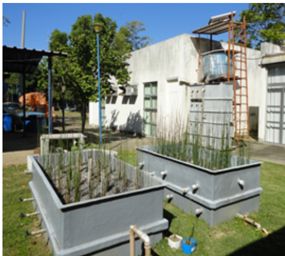
Sistemas do Tipo Wetlands no Parque Experimental UFES
