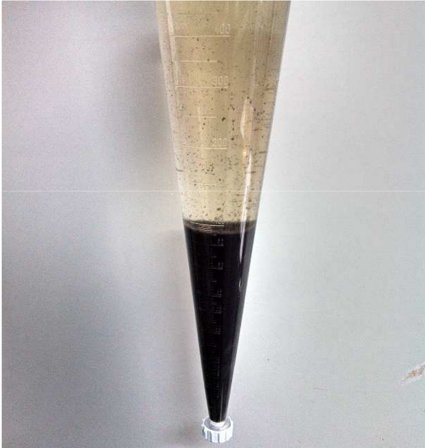
Efluente final com excesso de sólidos.
