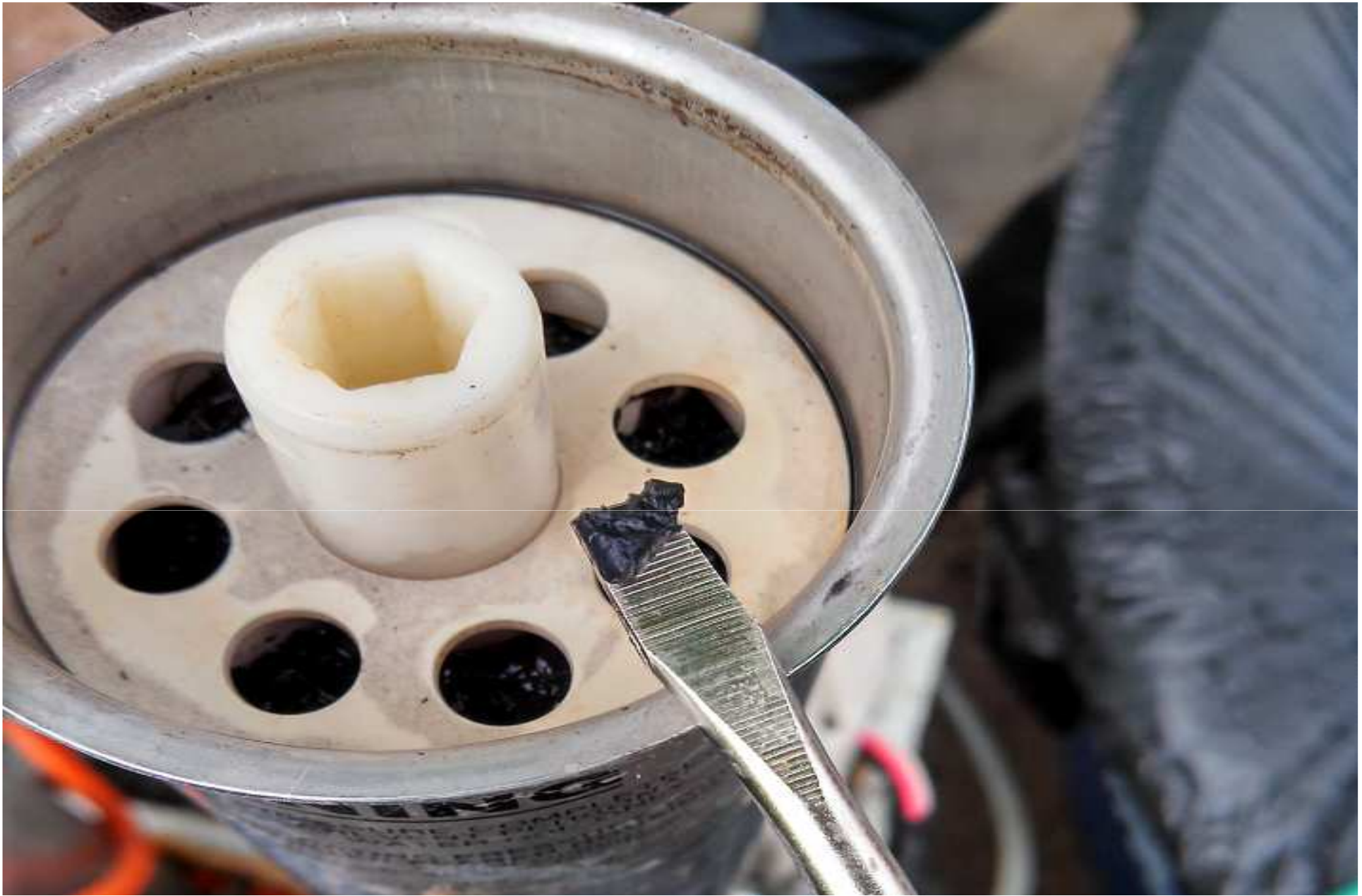
Sólidos retidos na superfície da membrana
