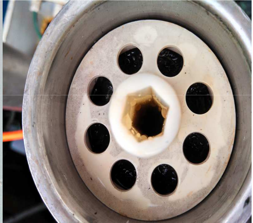
Entupimento da membrana no piloto de nanofiltração causado pelo excesso de sólidos no efluente.
